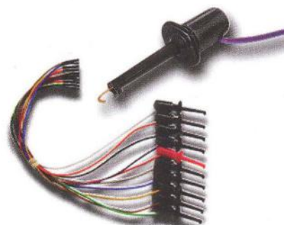
Obr. 5. K BS10U se dodává sada měřících hrotů s háčky pro zachycení do obvodu
