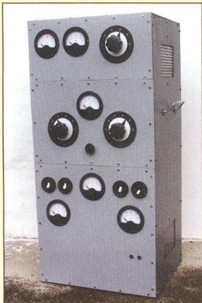
Obr. 4. Prototyp vysílače Microphona VMK 514 s údajným dosahem z bunkru 10 km (replika)
