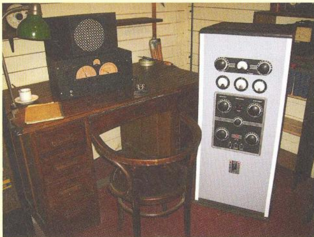
Obr. 1. Vybavení VRÚ přijímačem RME-69 a vysílačem od RCA typu ACT-150 (repliky)
