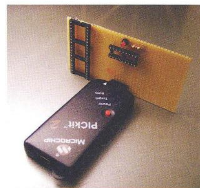
Obr. 2. Prípravok zhotovený na univerzálnej doske
