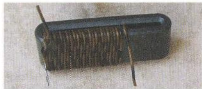
Obr. 16. Výstupní transformátor na odrušovacím feritovém jádře
