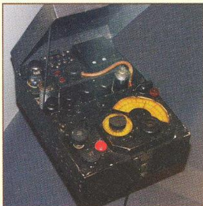
Obr. 13. Přijímač „MARJÁNKA“ konstruktéra Šimandla, elektronky 6K8, 6SK7 (3x), 6SR7, 5Z4
