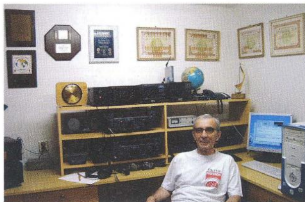
Ing. Miloš Prostecký, OK1MP, ve svém ham-shacku. Zařízení: dva transceivery YAesu FT-1000MP MARK-V, transvertor FTV-1000 pro pásmo 50 MHz a další transvertor TR-70H pro 70 MHz. Na stěnách trofeje: diplomy DXCC, plakety 5BDXCC, WPX Award of Excellence, 5BWAZ, DXCC Challenge 2500
