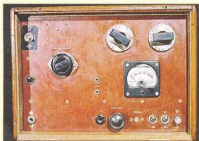
Obr. 6. Vysílač MARK III, elektronky 6V6 (6L6), 807 (vlevo)
